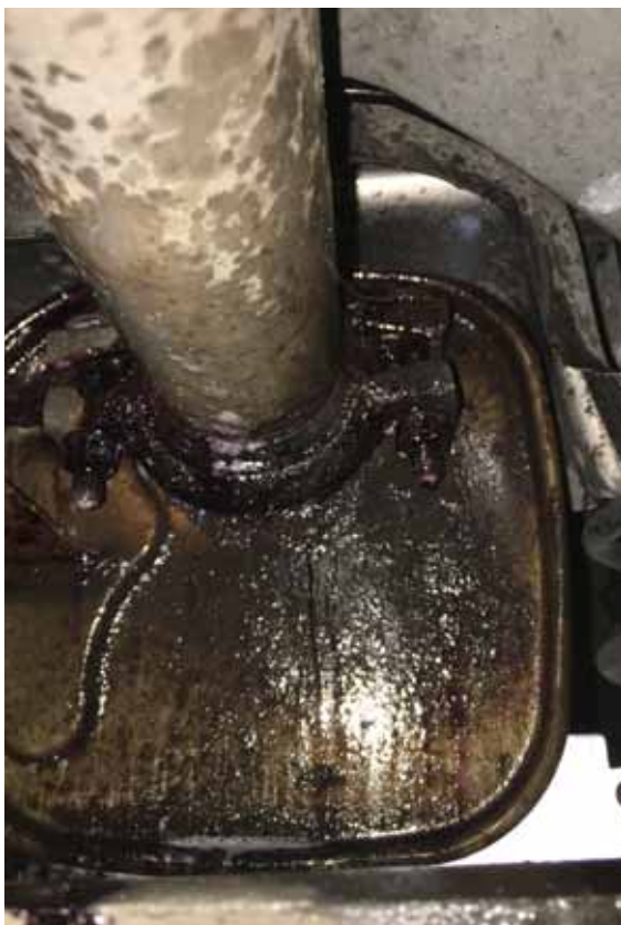
Leon: "Een van de nadelen is dat Reactor moeilijk te doseren is. De uitlaatklem komt uiteindelijk wel zonder problemen los."
