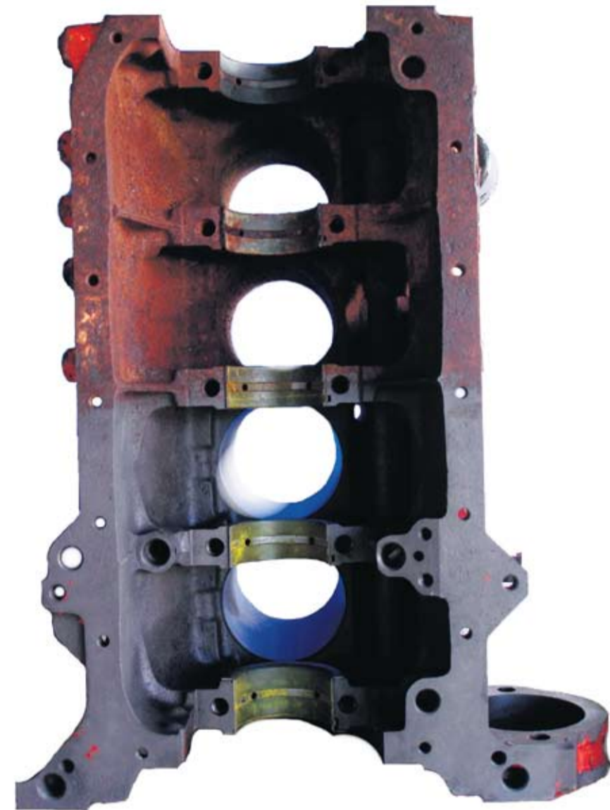
Een roestig motorblok gedeeltelijk behandeld met Rustyco. (Foto's Rustyco)
